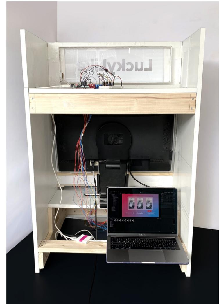
Abb. 64 LuckyLike, Verkabelung der Drucktaster und LED-Streifen
